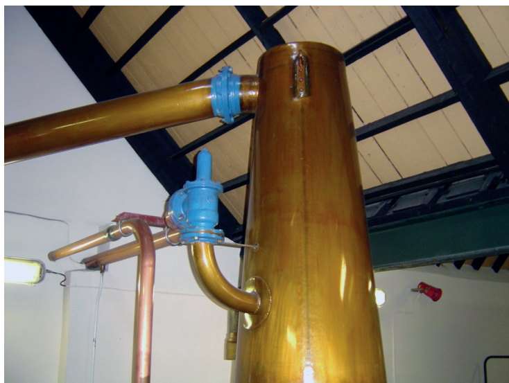
Detail plochého vršku přepalovacího kotle v palírně Cragganmore
